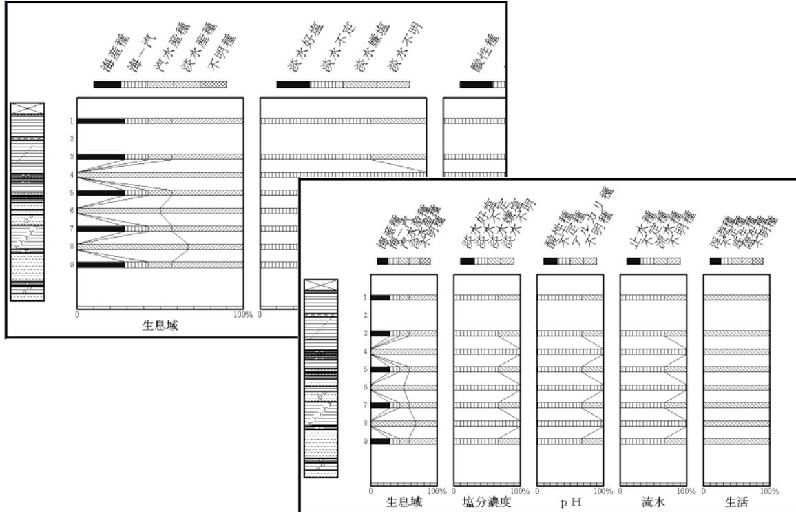
図 5-120 「グラフ幅」の変更 (奥：設定前(50mm)、前：設定後(20mm))
