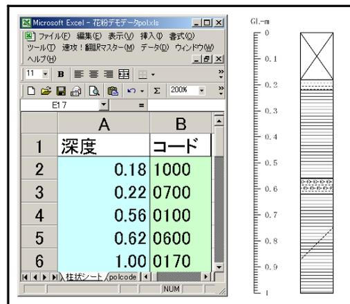
図 3-6 「柱状シート」の入力例と打ち出した柱状図
