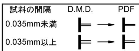
図 6- 8 試料の間隔による細線の状態
